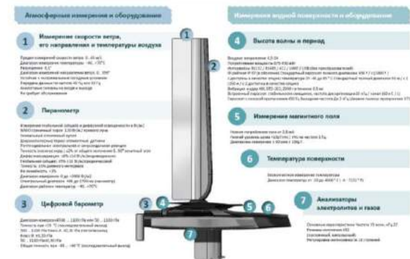
Рис. 6. Описание функционала морской многоцелевой беспилотной платформы: 1 – измерение скорости ветра, его направления и температуры воздуха; 2 – пиранометр; 3 – цифровой барометр; 4 – высота волны и период; 5 – измерения магнитного поля; 6 – температура поверхности; 7 – анализаторы электролитов и газов.
