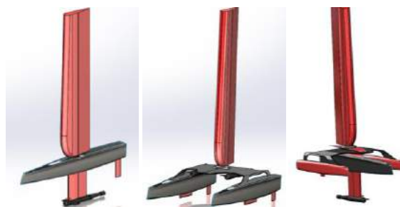
Рис. 1. Модификации морской многоцелевой беспилотной платформы (слева направо – монокорпус, катамаран, тримаран)
