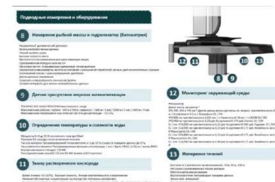
Рис. 7. Описание функционала морской многоцелевой беспилотной платформы: 8 – измерение рыбной массы и батиметрия; 9 – датчик присутствия морских млекопитающих; 10 – определение солёности воды; 11 – замер растворенного кислорода; 12 – датчики мониторинга окружающей среды; 13 – измерения течений.
